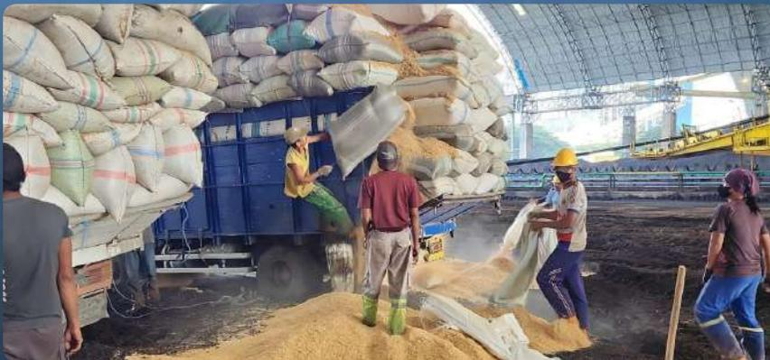
Hasil uji coba menunjukkan bahwa sekam padi dapat digunakan sebagai bahan bakar pengganti batubara dalam *co-firing* dengan bauran 3% dari total 204 ton *coal flow* per jam atau sekitar 6,12 ton per jam.
